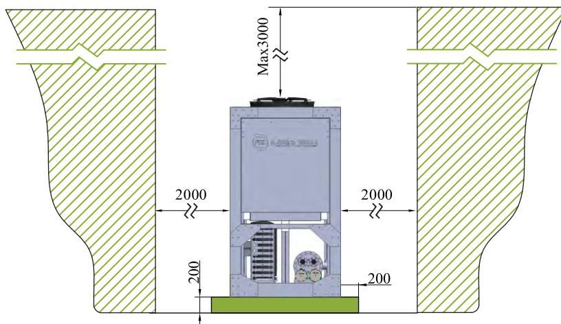
\* توصیه میگردد که دستگاه در فضایی با رعایت حریم کافی و لازم جهت گردش هوا و سرویس دهی مناسب نصب گردد.
