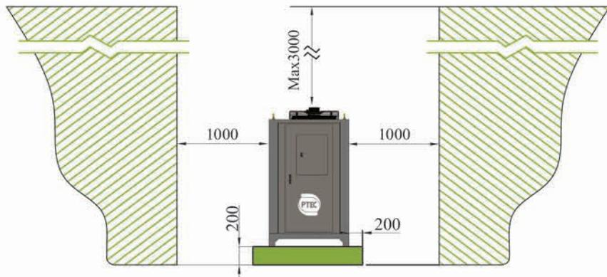
\* توصیه میگردد که دستگاه در فضایی با رعایت حریم کافی و لازم جهت گردش هوا و سرویس دهی مناسب نصب گردد.
